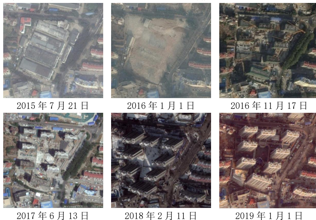
图5 利用0.5米分辨率光学卫星持续监测住宅地产工地施工进展（来源：中科星睿）
